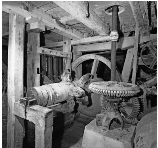
Der Antrieb. An der Achse rechts lief nicht nur die Knochenstampfe, sondern im Obergeschoss auch eine Futtermühle.
